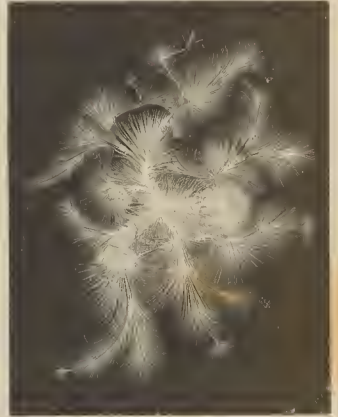
Fig. 2. — Descarga negativa de una bobina de Ruhmkorff
